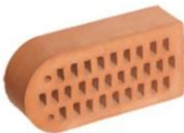
КИРПИЧ КЕРАМИЧЕСКИЙ ФАСОННЫЙ ТИП Ш-1 ТУ 5741-001-43860397-00 Радиус: R60 Морозостойкость: F60 ..
