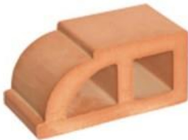
КИРПИЧ КЕРАМИЧЕСКИЙ ФАСОННЫЙ ЗАБОРНЫЙ ТУ 5741-001-43860397-00 Радиус: R80 Морозостойкость: F50 ..
