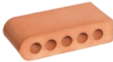
КИРПИЧ КЕРАМИЧЕСКИЙ ФАСОННЫЙ ТИП Ш-31 ТУ 5741-001-43860397-00 Радиус: R33 Морозостойкость: F50 ..
